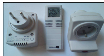
Deux compteurs de consommation reliés à un afficheur sans fil
